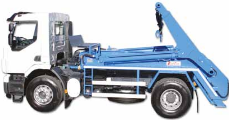
Equipo de Brazos Telescópicos. Mandos en interior y exterior de cabina. Patas traseras hidráulicas e independientes.
