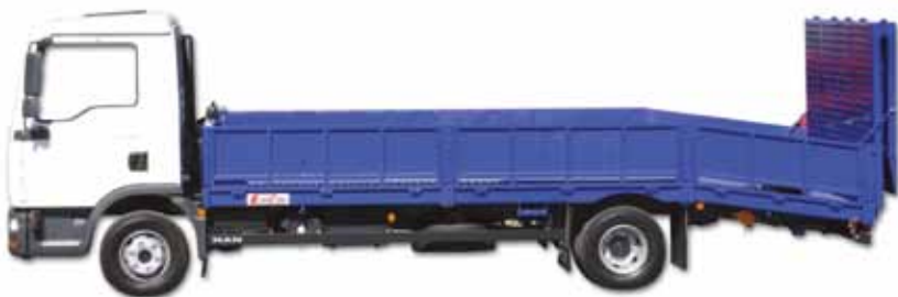
Zaga basculante con extensión y patas hidráulicas
