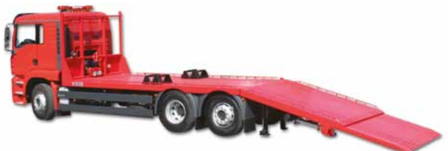
Zaga basculante con extensión y patas hidráulicas
