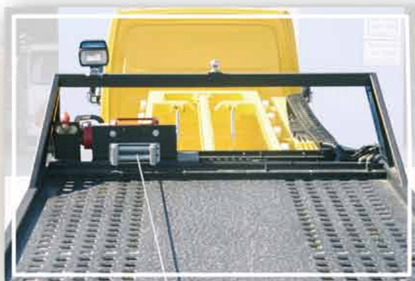
Desplazamiento lateral hidráulico del cabrestante por telemando
