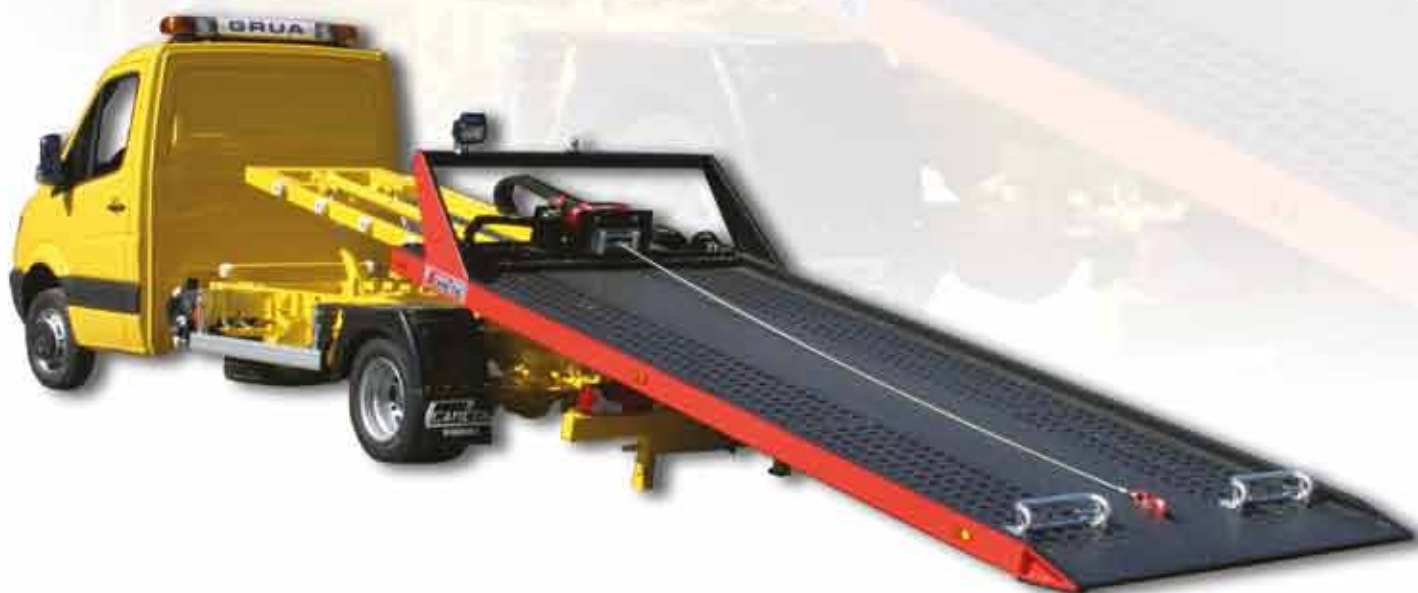
Desplazamiento lateral hidráulico del cabrestante por telemando
